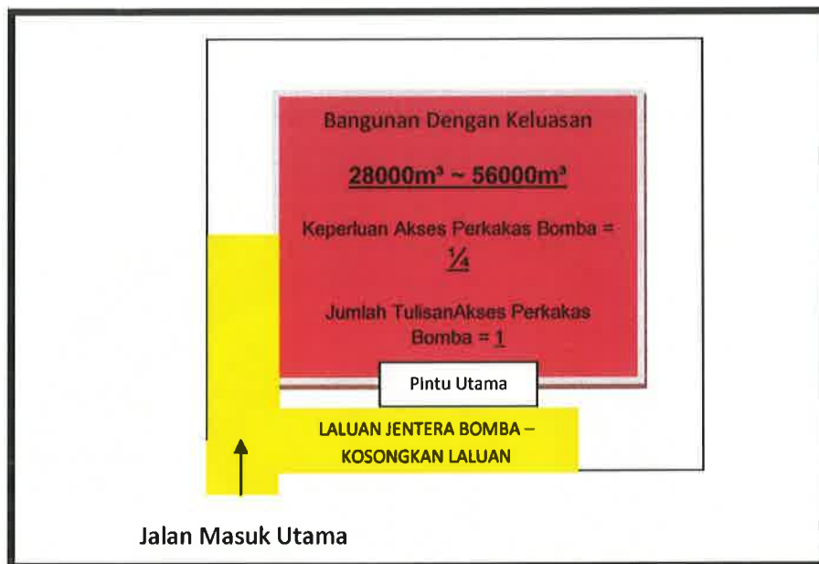
Rajah 2: Contoh keperluan mengadakan akses perkakas bomba
